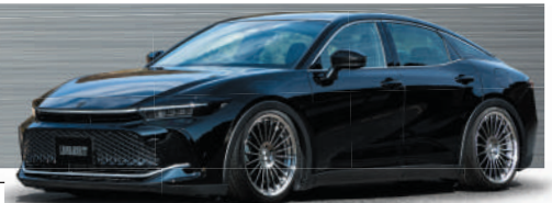
TOYOTA CROWN CROSSOVER COLOR: TITAN GRADATION NORMAL RIM (RIM OVER DISK) P.C.D: 5-114.3 SIZE: F 2190 INSET 37 245/40-21 R 2190 INSET 42 245/40-21 ※ローダウンが必要です。
