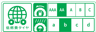
転がり抵抗性能:AAA ウェットグリップ性能:b/13サイズ
